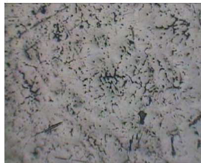
(b) Al6061-8wt.% TiO 2 , Water Quenched
