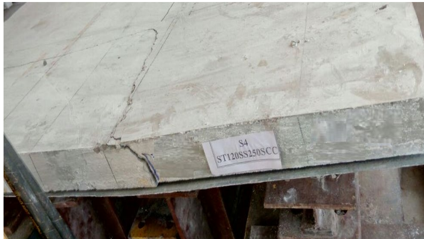
Fig. 18. De-bonding of FST2SS2 composite slab
